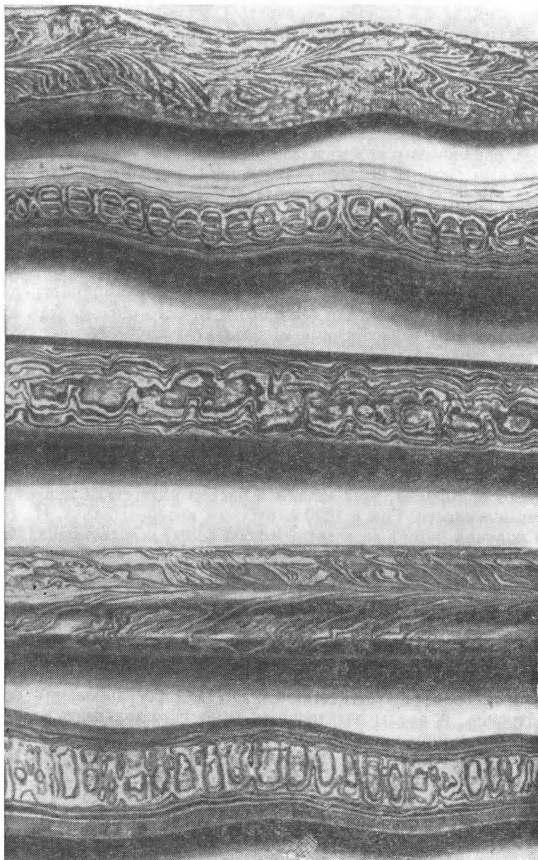
Рис. 48. Структура стали старинных сабель.
